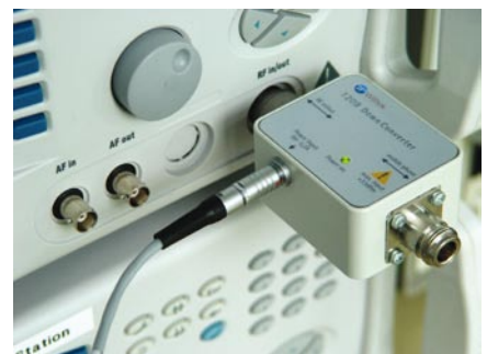
图 2: 1209下转换器是用于蓝牙和GPS测试的可选频率扩展。
